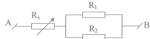
**Bài tập 2:** Cho dây dẫn làm bằng nikelin có  $\rho = 0,4 \cdot 10^{-6} \Omega \cdot m$ , đường kính tiết diện 1,5 mm, chiều dài dây là 80m.
