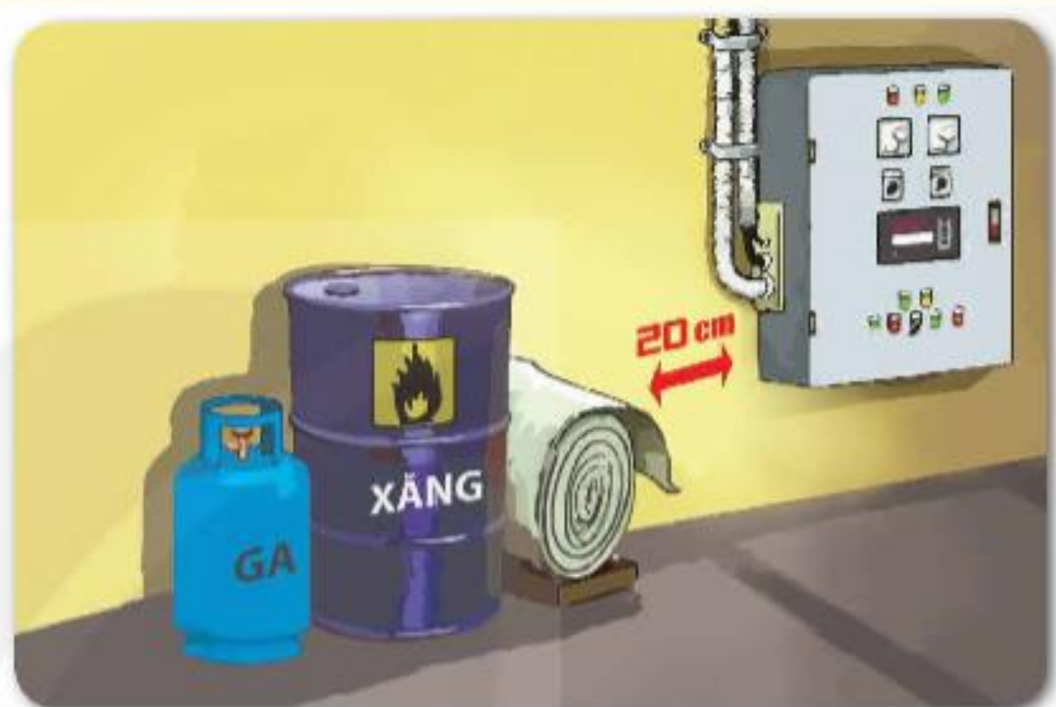
b) Chất đốt để gần tủ điện
